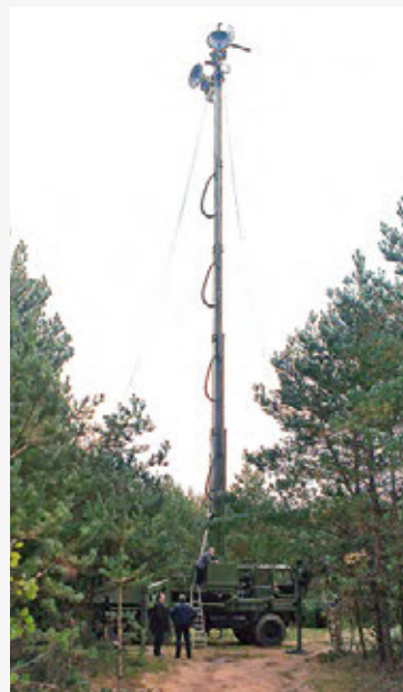
Цифровая релейная станция на мобильной и быстро разворачиваемой платформе Р-414МБРП «Сосна-2»
