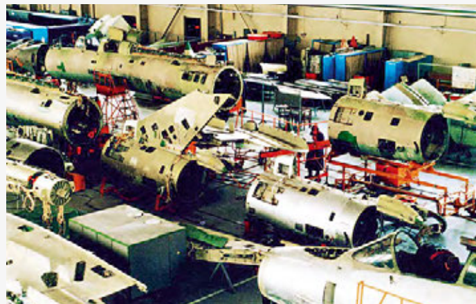
Ремонт самолетов Су-22 на 558 Авиацiонном ремонтном заводе
