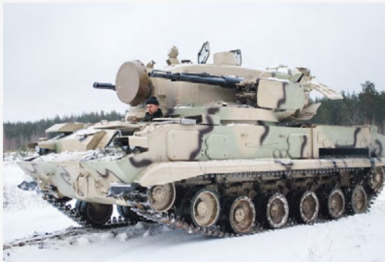
Гусеничные шасси ГМ-352 для зенитного пушечно-ракетного комплекса «Тунгуска» выпускались на Минском тракторном заводе
