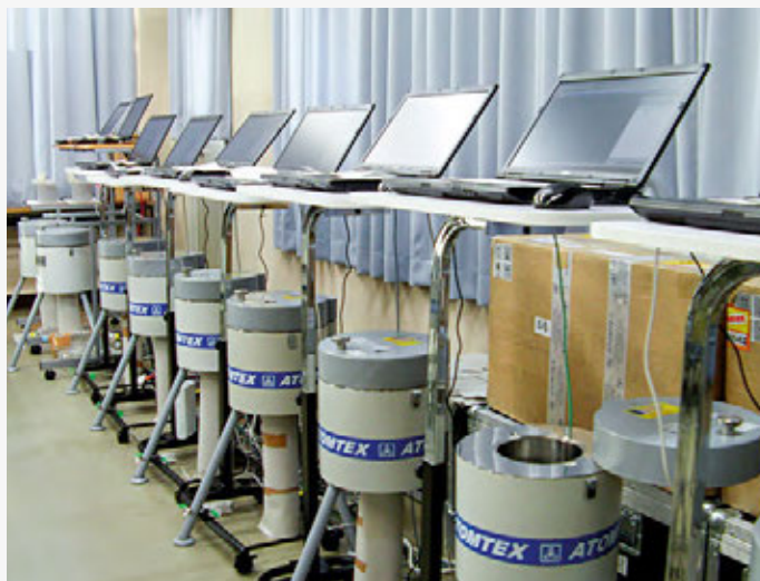
Агрохимическая лаборатория в Японии, оснащенная гамма-радиометрами РКГ-АТ1320
