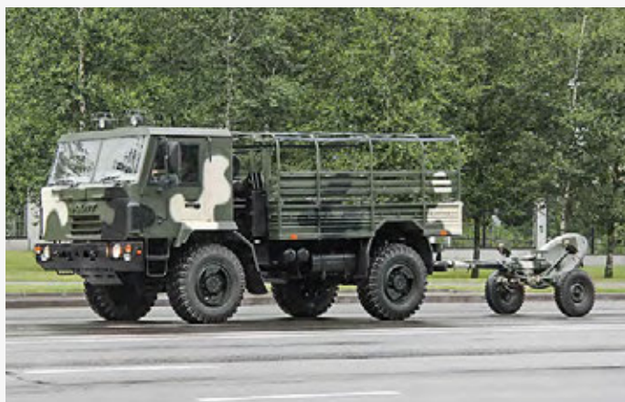
Транспортное шасси МЗКТ-500200-030 буксирует нарезной полуавтоматический миномёт 2Б23 «Нона-М1»
