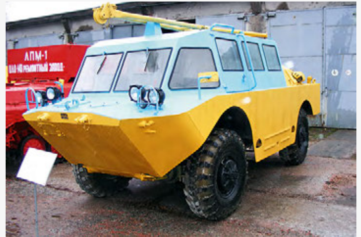
Аварийно-транспортная машина «Алесья-1» выполнена на базе шасси бронированной разведывательно-дозорной машины БРДМ-2
